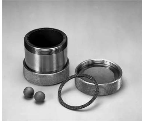
Figura 1. Recipiente y medio de molienda utilizados en el proceso de aleado mecánico.
