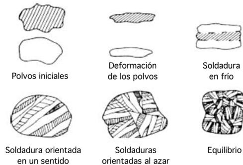
Figura 3. Esquema que representa los diferentes eventos que ocurren con los polvos durante el aleado mecánico.
