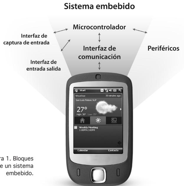
Figura 1. Bloques básicos de un sistema embebido.
