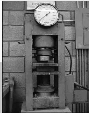
Realización de la prueba de compresión simple.
