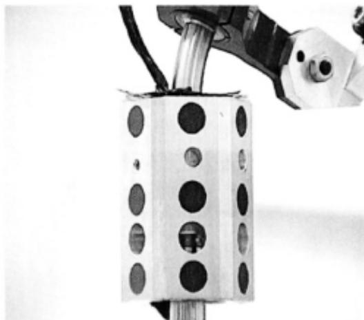
Figura 2.15: Imagen de las señales luminosas adheridas a la herramienta del manipulador.
