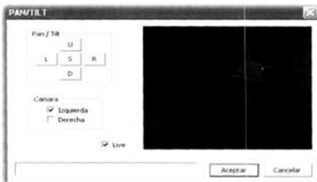
Figura 66. Ventana de control manual de las plataformas giratorias
