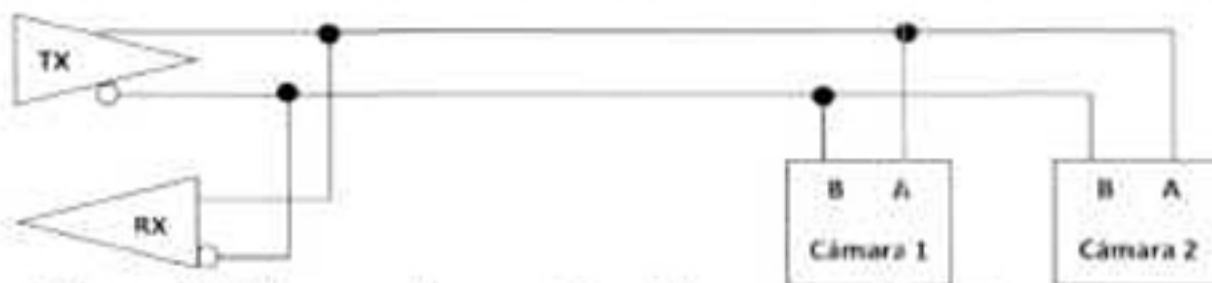
Figura 33. Diagrama de conexión de la computadora y las cámaras
