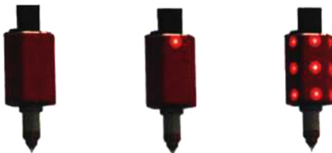
Figura 7. Marcas visuales artificiales colocadas alrededor de la herramienta de corte
