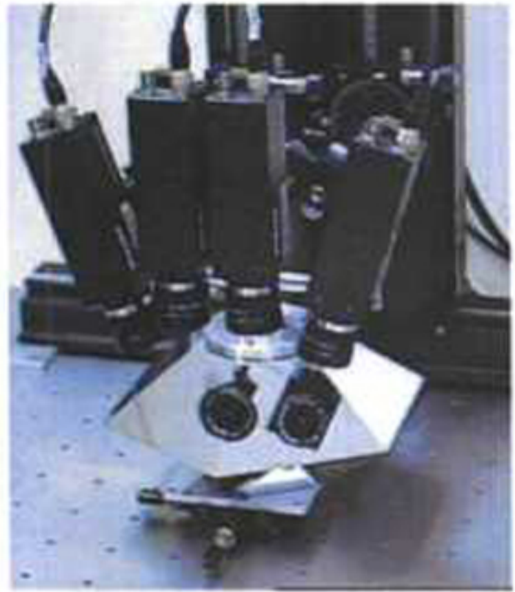
Figura 3. Uso de múltiples espejos para incrementar el campo visual
