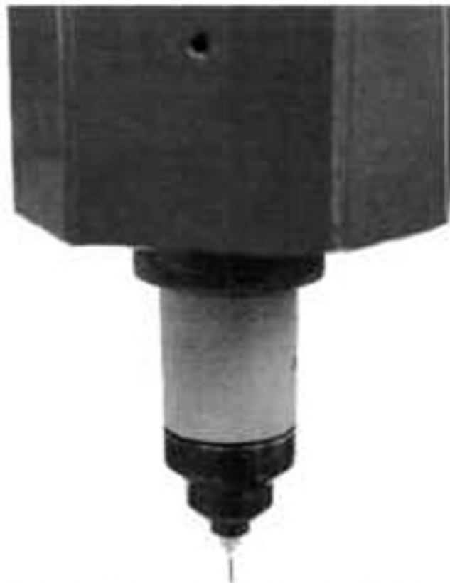
Figura 52. Aguja colocada en la punta de la herramienta
