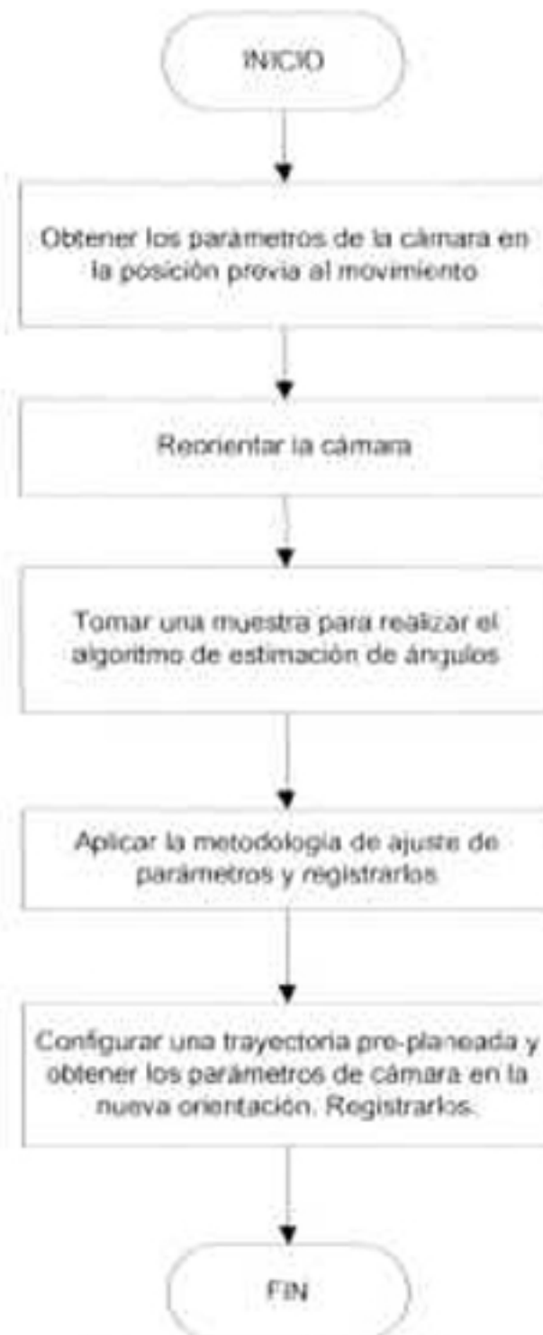
Figura 39. Diagrama de flujo para realizar el experimento de comparación de parámetros de cámara antes y después de la reorientación.
