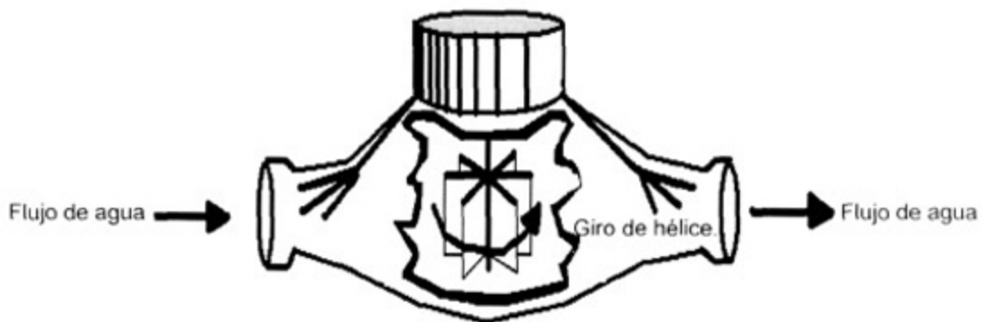
Lámina 4.5 Medidores de turbina.
