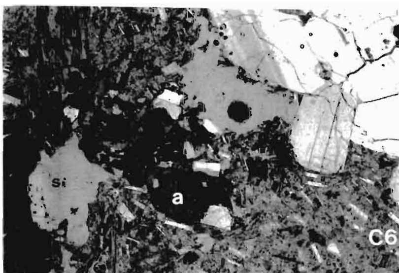
Lamina delgada No. C6 de litico de la avalancha LP y 5X, Andesita con textura porfidica seriada, con cristales de plagioclasa p, anfibol a y silice criptocristalina si.
