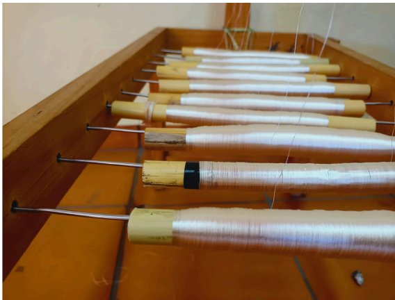
Imagen 5. Carrizos en los que se enreda el hilo en el proceso de devanado. Taller de la Escuela del Rebozo. Autoría propia.
