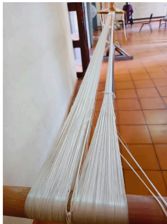
Imagen 7. Bastidor con los hilos dispuestos para la técnica de amarrado "ikat". Taller de la Escuela del Rebozo. Autoría propia
