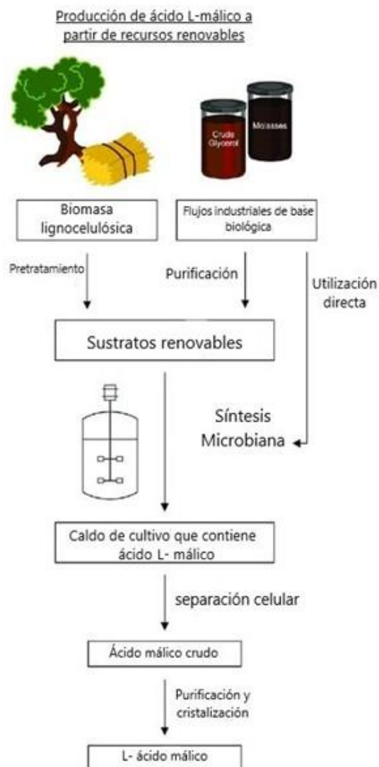
Figura 4. Esquema conceptual de producción de ácido málico a partir de residuos agroindustriales bajo un modelo de economía circular y biorrefinería (Kövillein et al., 2020).
