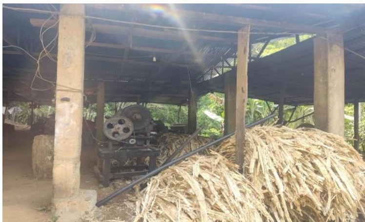
Imagen 6. Trapiche artesanal para la molienda de caña de azúcar ubicado en el SAPF 18
