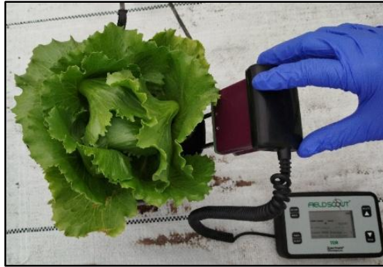
Figura 10. Equipo utilizado en la medición de conductividad eléctrica en suelo durante el cultivo de lechuga
