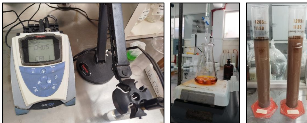
Figura 31. Determinación de textura, CE y materia orgánica del suelo después de la cosecha
