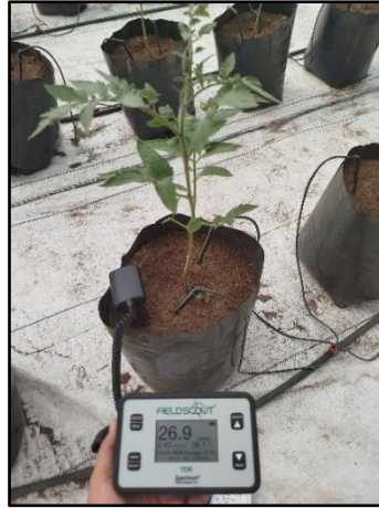
Figura 29. Equipo utilizado en la medición de conductividad eléctrica en suelo durante el cultivo de jitomate
