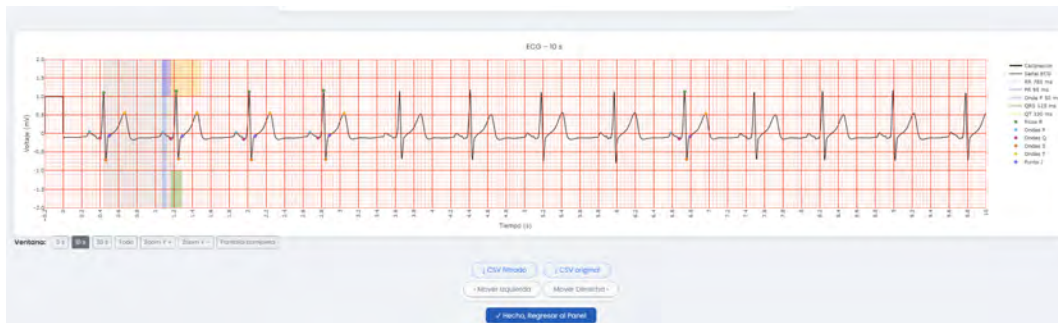
Figura 5.13: Gráfica ECG interactiva (Plotly) con anotación de ondas. La señal se presenta sobre una malla clínica, y se superponen marcadores que indican la posición aproximada de las ondas P, los complejos QRS y las ondas T. La vista es interactiva: el médico puede hacer zoom , desplazarse por la traza y encender o apagar capas de información, lo cual facilita la revisión detallada de segmentos concretos del ECG.
