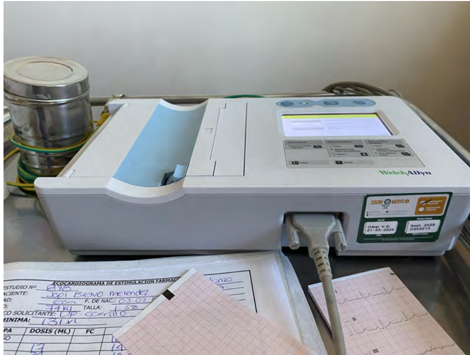
Figura 2.2: Electrocardiógrafo comercial (Welch Allyn) con papel cuadriculado e impresión de derivaciones I, II y III. Se usa como referencia de calidad de señal y de la interfaz tradicional para comparar con el sistema propuesto basado en OpenBCI.
