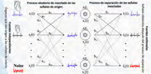
Figura 1 – Planteamiento del problema BSS para la extracción del ECG fetal
