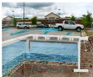
Infiltration structure | Estructura de infiltración
