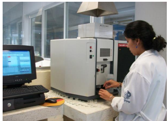
Anexo 12. Espectrofotometría de absorción atómica.
