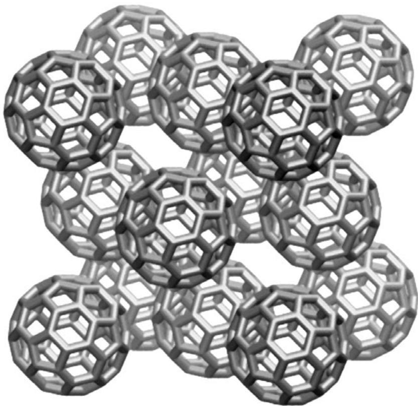
Figura 2. Aglomerado básico a partir del que se forma el cristal de fullereno o fullerita.
