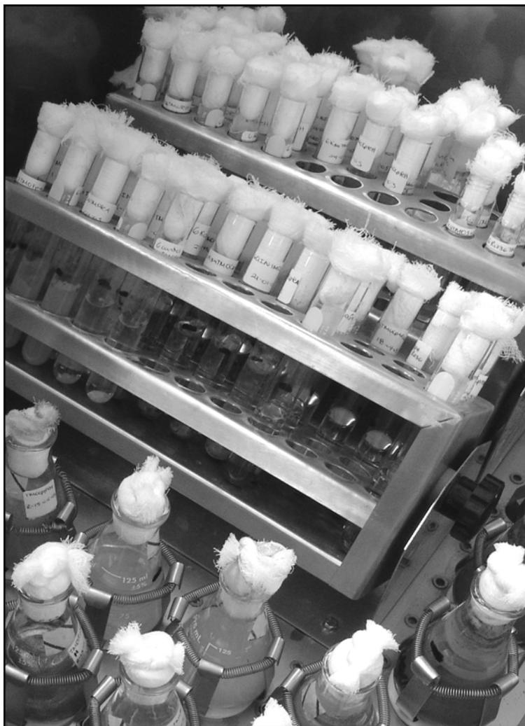
■ Estos matraces contienen microorganismos (Bacteria y/o Archea) termófilos (temperatura óptima de crecimiento entre 50 y 70°C) y acidófilos (desarrollo óptimo a pH 2.0) aislados de terreros mineros (pilas con minerales de baja ley o minerales secundarios) que son cultivados en el Laboratorio de Geoquímica y Geomicrobiología Ambiental del Instituto de Metalurgia de la UASLP.
