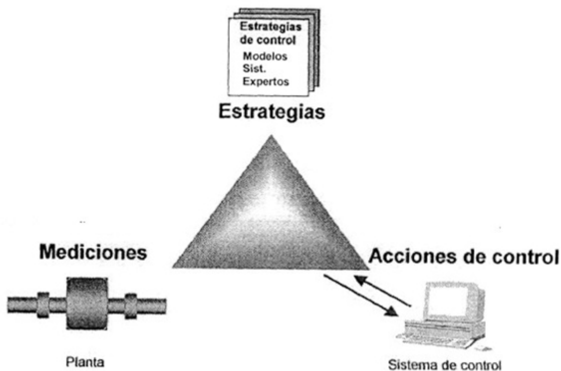
Figura 3.1. Triángulo de control, que muestra las partes esenciales de un sistema de control moderno (Herbst y Pate, 1999).
